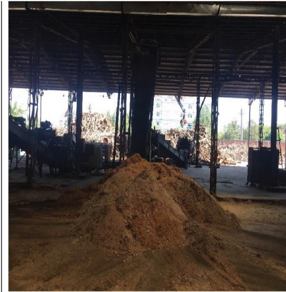
**Hình 4. Dăm gỗ không đủ tiêu chuẩn, mùn cưa, phế phẩm của chế biến dùng sản xuất viên nén**
